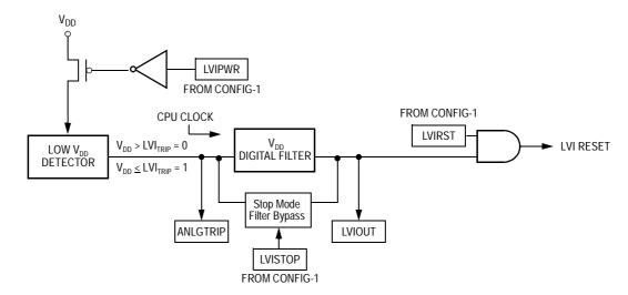
Figure 14-1. LVI Module Block Diagram
