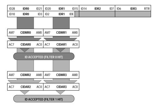
Figure 24-4. Dual 16-Bit Maskable Acceptance Filters
